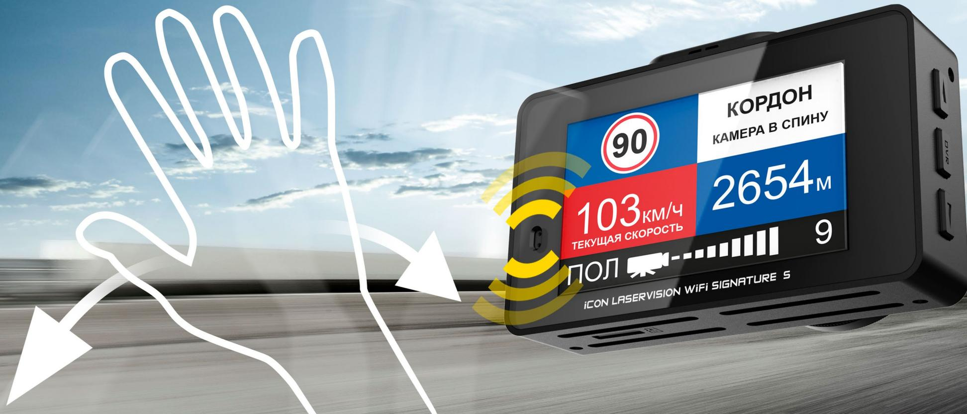
Технология Motion Operation™ позволяет одним движением руки отключить звуковое и голосовое предупреждения при приближении к радару или камере. Пользователю нужно лишь провести рукой перед экраном. Устройство отключит звук и включит только через 6 секунд после окончания оповещения.
